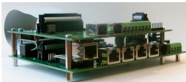
Obr. 2 - Hlavní a rozšiřující DPS
